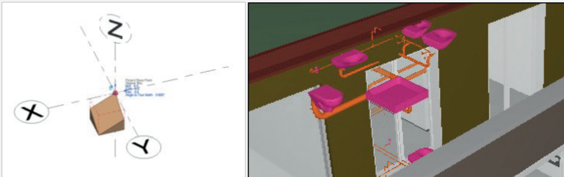
Abbildung 5: Beispiel eines Koordinationskörpers (links) und eines nicht koordinierten Projektursprungs (rechts)
